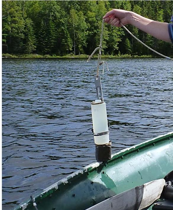
Photo 2. Bouteille lestée utilisée pour prendre un échantillon dans la colonne d'eau
